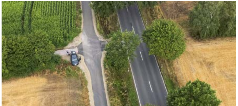
Für die außerörtlichen Zweirichtungs-Radwege ist eine Breite von mindestens 2,50 Meter als Standard definiert worden, der Radweg Lathwehren-Ostermunzel ist 3 Meter breit, dafür ist er für landwirtschaftlichen Verkehr freigegeben.
